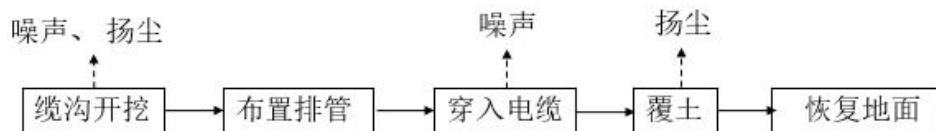
图 6 电缆直埋敷设施工工艺流程图
