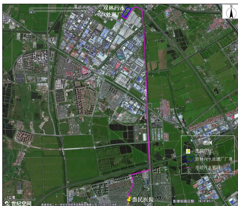
图 2-8 企业污水排口至污水处理厂管路图
