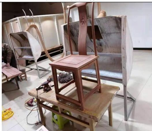
打磨工序集气管道
