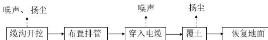
图 4 电缆直埋敷设施工工艺流程图
